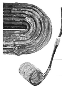
Verkalkung auf Heizschleifen
